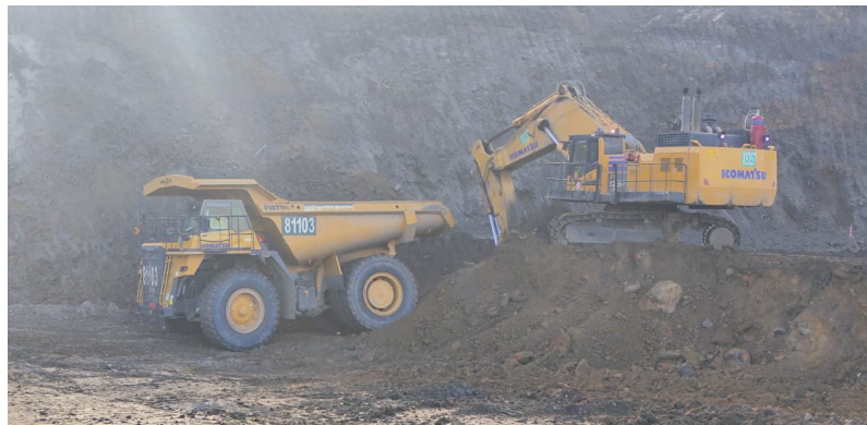
Gambar 7. Tinggi jenjang excavator loading material blasting
