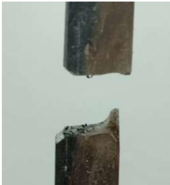
Gambar 5. Hasil pengamatan visual (makro) pada spesimen 2 dengan campuran serat ijuk 25%, serat sabut kelapa 25 % dan resin epoxy 50%
