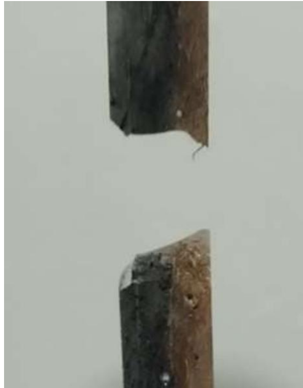
Gambar 6. Hasil pengamatan visual (makro) pada spesimen 3 dengan campuran serat ijuk 30%, serat sabut kelapa 20 % dan resin epoxy 50%
