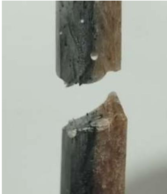
Gambar 4. Hasil pengamatan visual (makro) pada spesimen 1 dengan campuran serat ijuk 20%, serat sabut kelapa 30 % dan resin epoxy 50%.
