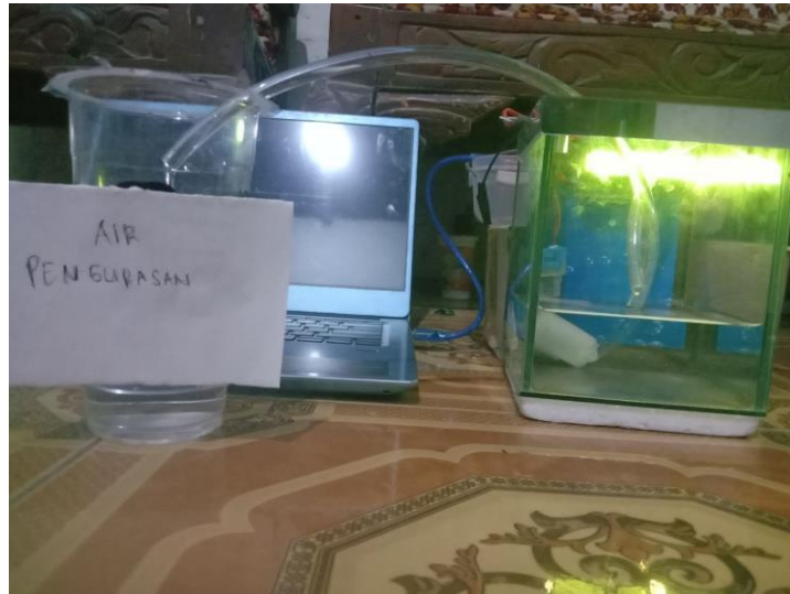
Gambar 10. Pompa 1 Menguras Air
